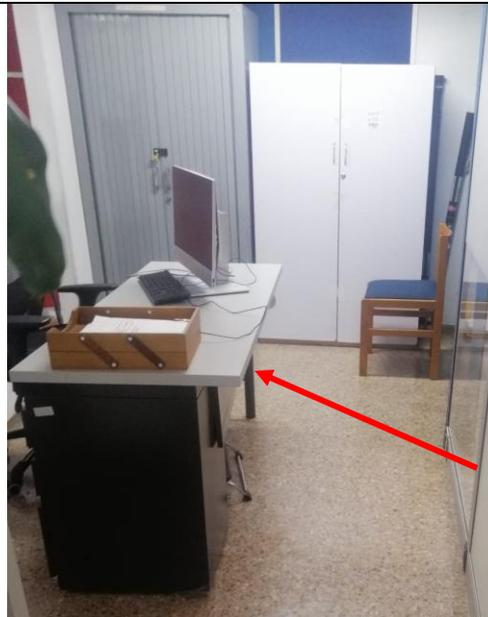
Se evidencia que el módulo de atención al ciudadano presenta debilidades en cuanto a las dimensiones especificadas en la norma para de la superficie de trabajo de 60 cm, la cual no permite la aproximación frontal por parte de los usuarios de sillas de ruedas, la orientación de la superficie de trabajo no permite el ingreso y la maniobrabilidad de una silla de ruedas.
