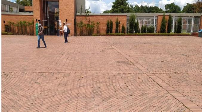
Se identificaron debilidades en la señalización respecto de indicadores táctiles en la superficie peatonal para indicar la orientación, como ruta táctil, patrón de guía podó táctil, además de un sistema y/o equipo de información audible.
