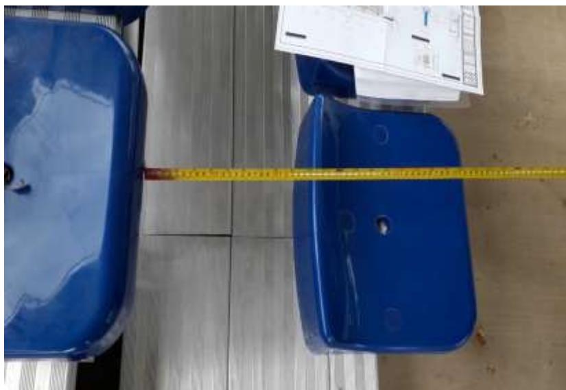
Fotografía N° 460. Espacio entre las filas de 26 cm - foto tomada por el equipo auditor.
