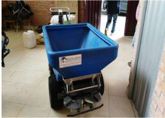
Foto No. 72: Detalle máquina arenera para nivelar y fertilizantes. Se observa el balde en material plástico. Fuente: Equipo Auditor CGR
