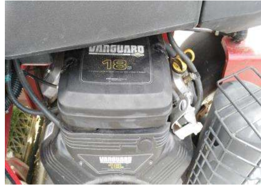
Foto No. 73: Detalle motor equipo para poda tractor profesional. Se aprecia que la potencia del mismo corresponde a 18 HP.
